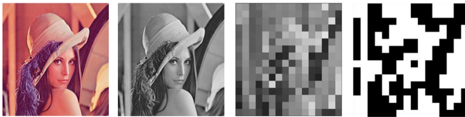
Abbildung 1: Beispiel Blockhash. Links das Ausgangsbild, welches erst in Graustufen umgewandelt und dann auf 16x16 Pixel verkleinert wird. Der Median der Grauwerte bildet dann die Grenze für die binäre Einordnung rechts.
